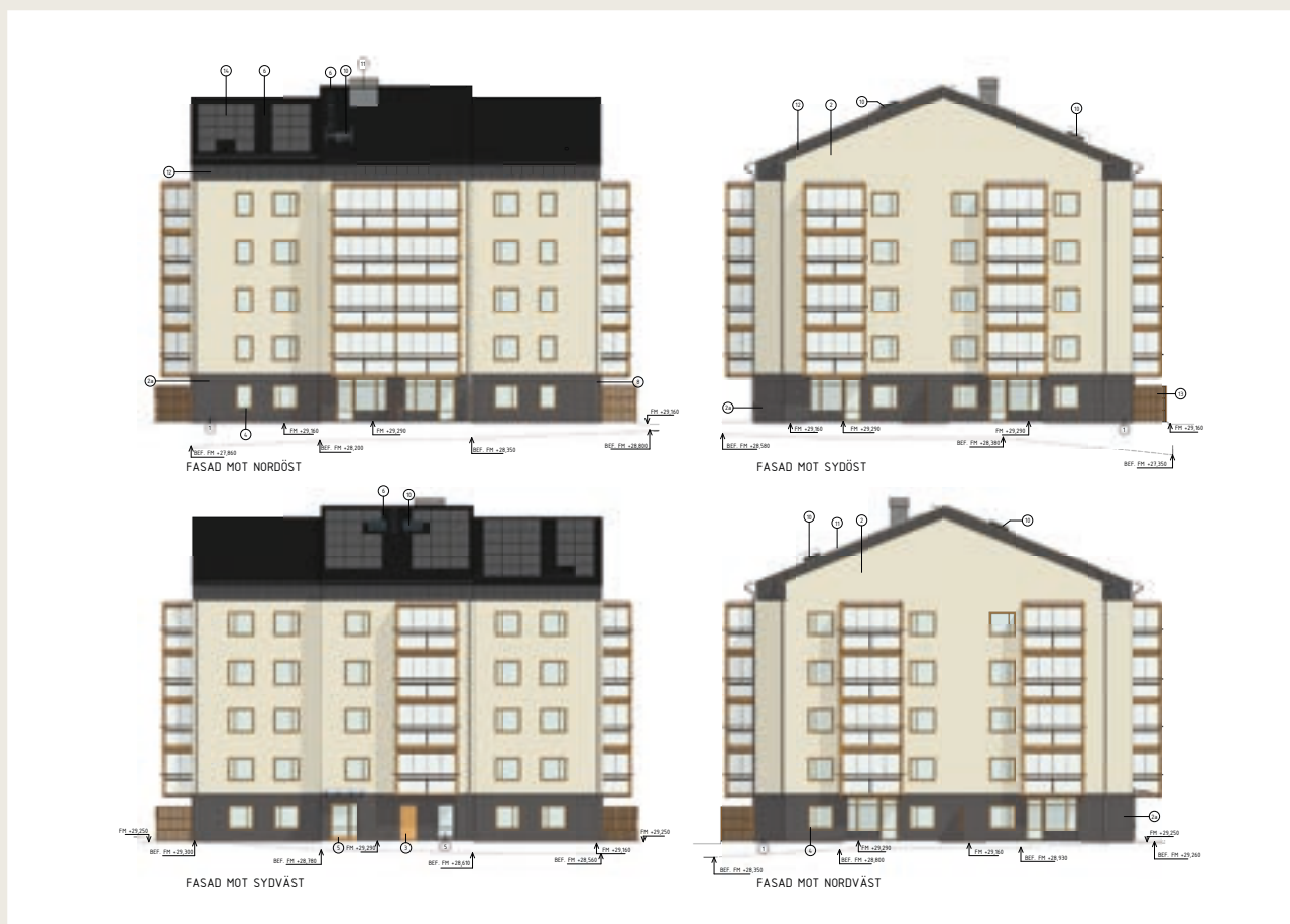
Korrekt färgsättning av huset (Kulör NCS-S 1005), samt placering av balkonger.
